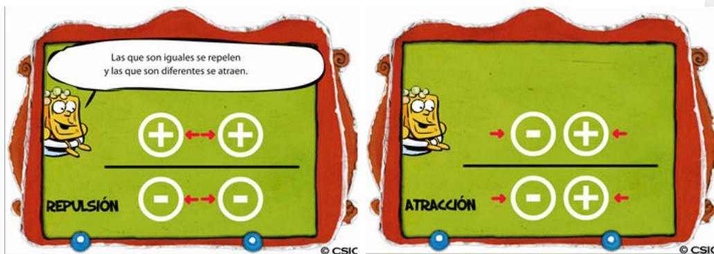
Imagen 2. Fuerzas de atracción y repulsión entre cargas eléctricas.
